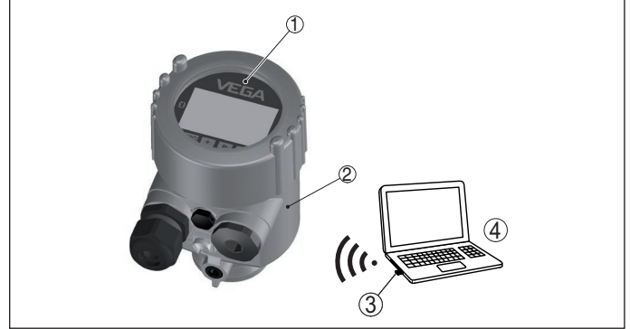
Res. 46: Bilgisayarların Bluetooth-USB adaptörü üzerinden bağlantısı
