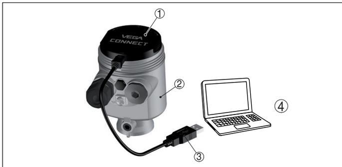
Abb. 44: Anschluss des PCs via VEGACONNECT und USB
