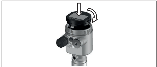
Fig. 4: Montage du module d'affichage et de réglage dans le boîtier à chambre unique se trouvant dans le compartiment de l'électronique
