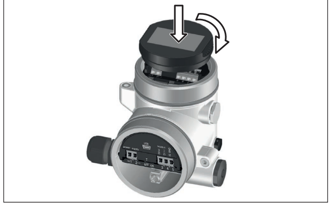
Res. 5: Gösterge ve ayar modülünün yerleştirilmesi
