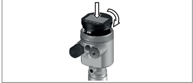
Res. 4: Elektronik bölümünde bir hücreli gövdede gösterge ve ayar modülünün çalıştırılması
