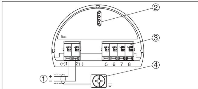
Fig. 5: Compartimento de conexão - Caixa de duas câmaras
