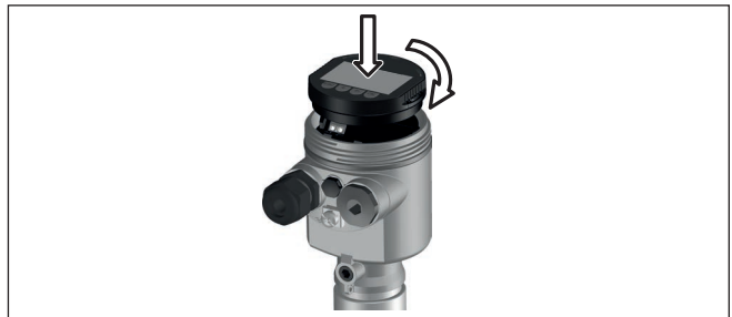
Abb. 4: Einsetzen des Anzeige- und Bedienmoduls beim Einkammergehäuse im Elektronikraum
