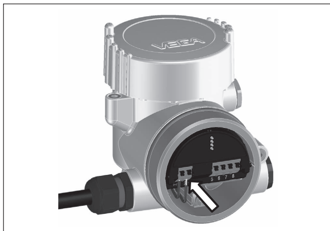
Figura 2: Operazioni di collegamento 5 e 6
