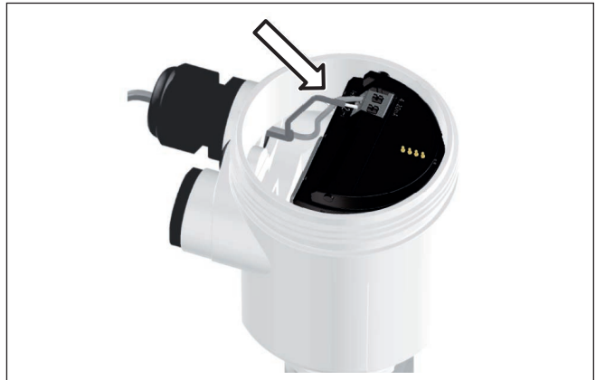
Abb. 2: Anschlusschritte 5 und 6 - Einkammergehäuse
