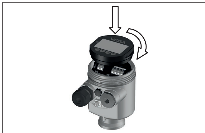
Fig. 6: Colocação do módulo de visualização e configuração na caixa de uma câmara no compartimento do sistema eletrônico
