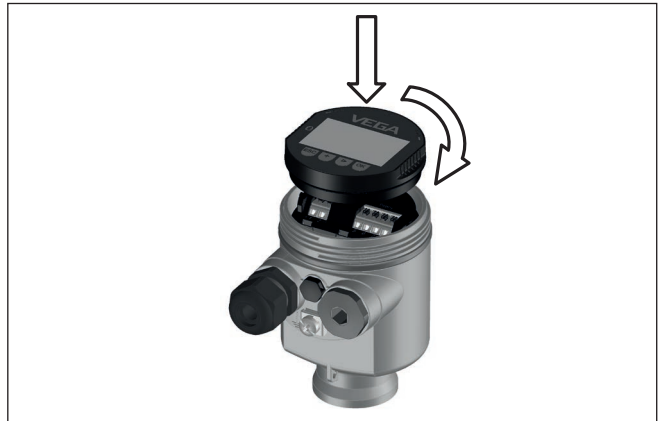
Fig. 6: Montage du module d'affichage et de réglage dans le boîtier à chambre unique se trouvant dans le compartiment de l'électronique
