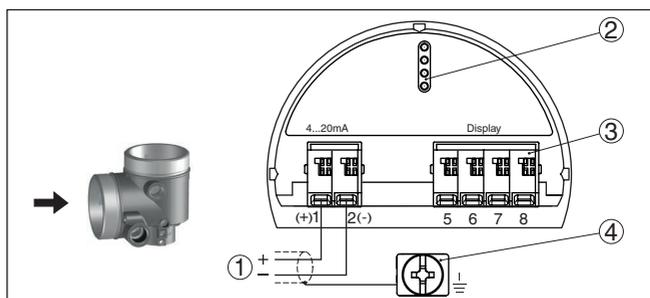
Fig. 4: Compartimento de conexão - Caixa de duas câmaras
