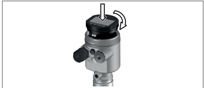
Fig. 4: Colocação do módulo de visualização e configuração na caixa de uma câmara no compartimento do sistema eletrónico
