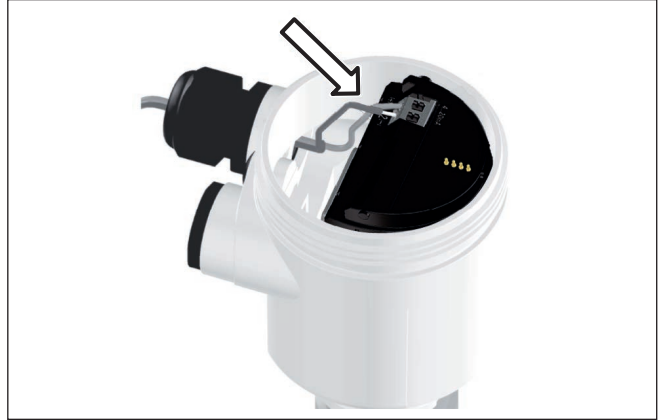
Res. 2: 5. ve 6. bağlantı adımları - Tek hücreli gövde
