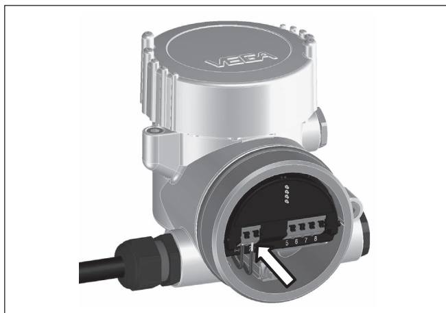
Rys. 8: Czynnności przy podłączaniu 5 i 6
