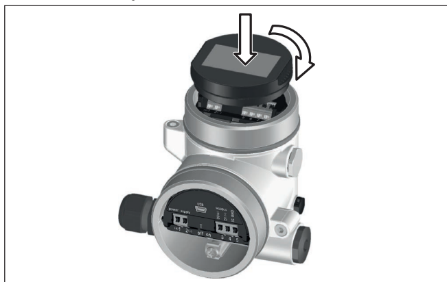
Fig. 15: Colocação do módulo de visualização e configuração
