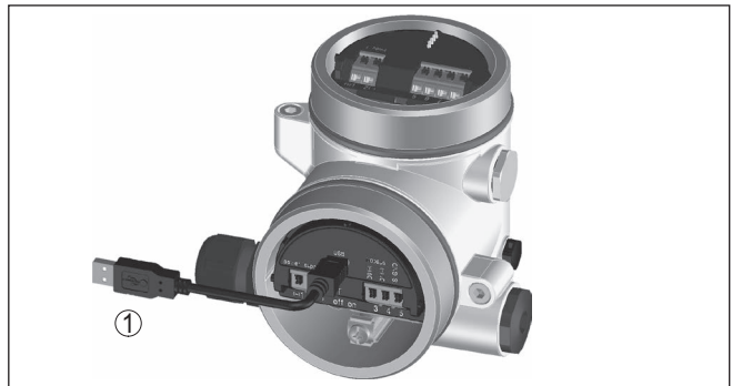
Figura 20: Collegamento del PC all'elettronica Modbus via USB
