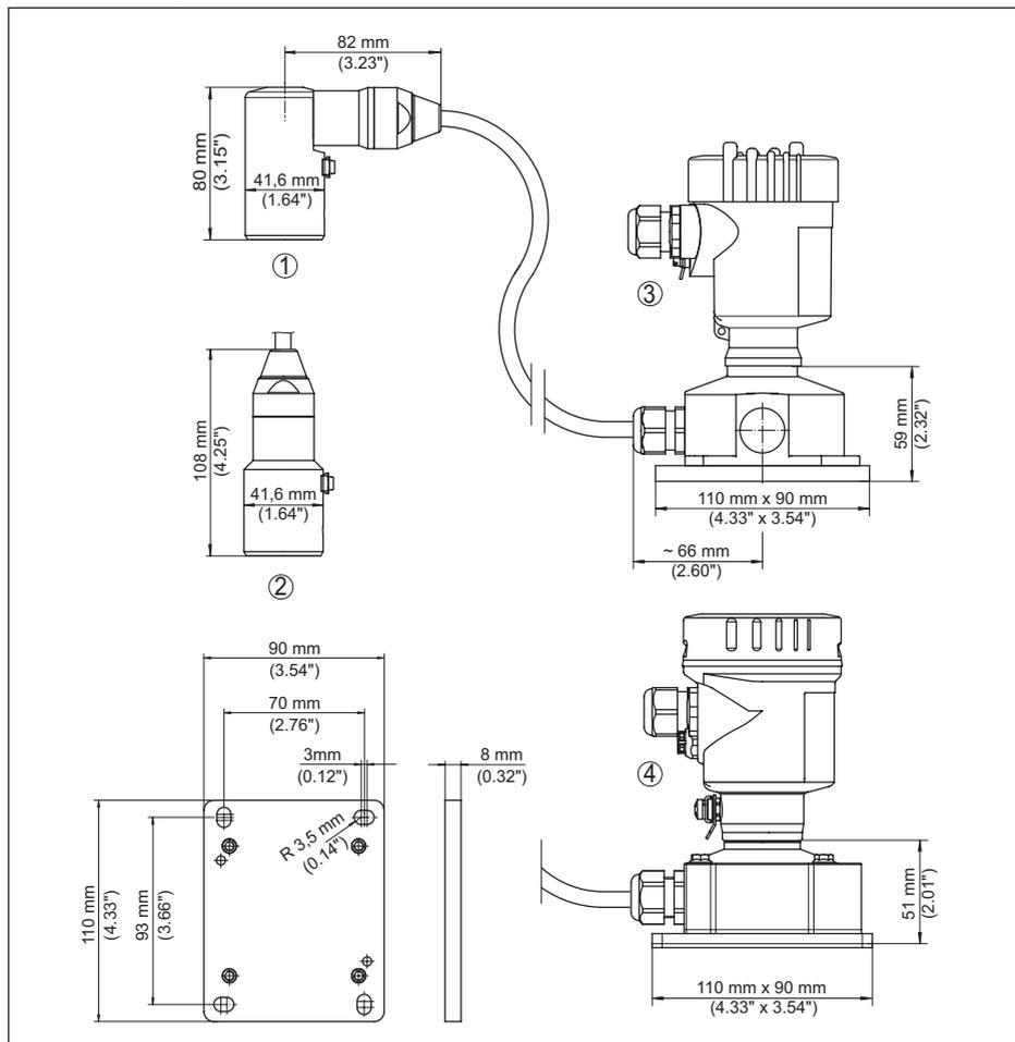
Fig. 30: VEGABAR 86, version IP68 avec boîtier externe
