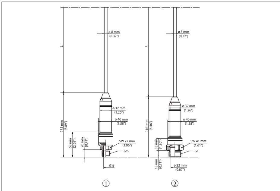
Fig. 36: VEGABAR 86, version filetée
