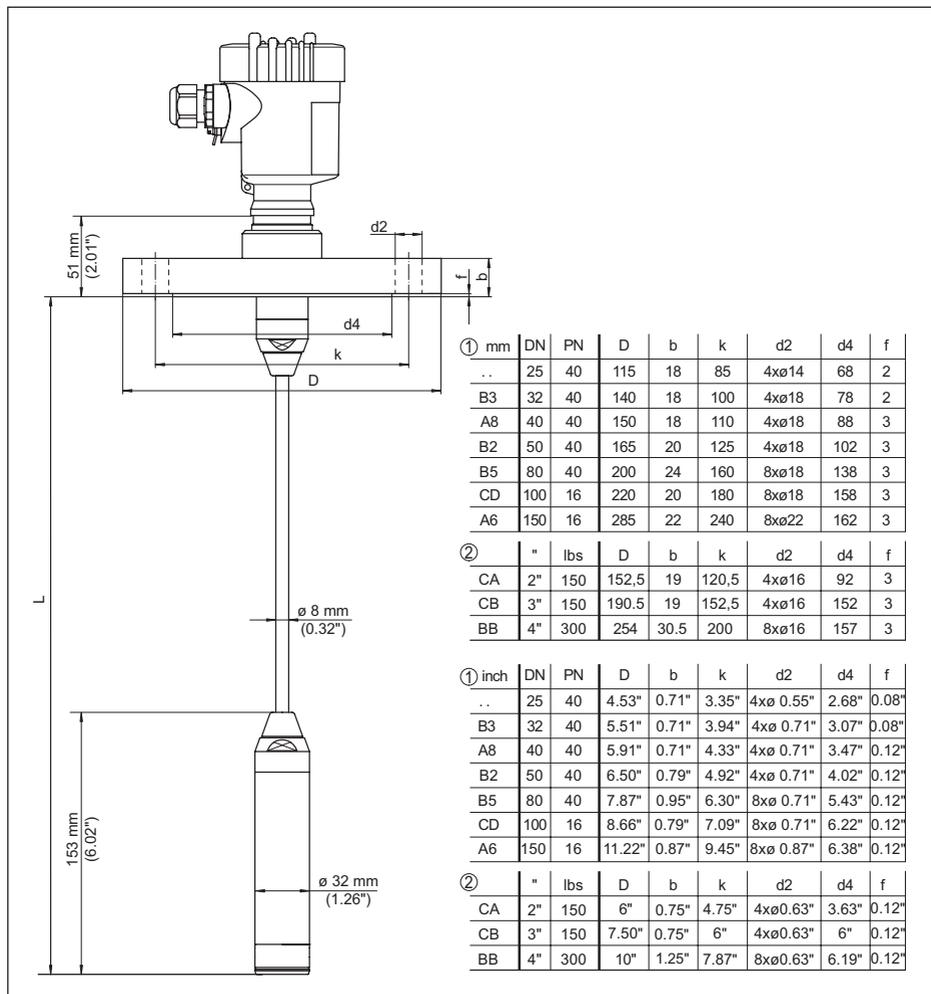
Fig. 34: VEGABAR 86, raccord à bride
