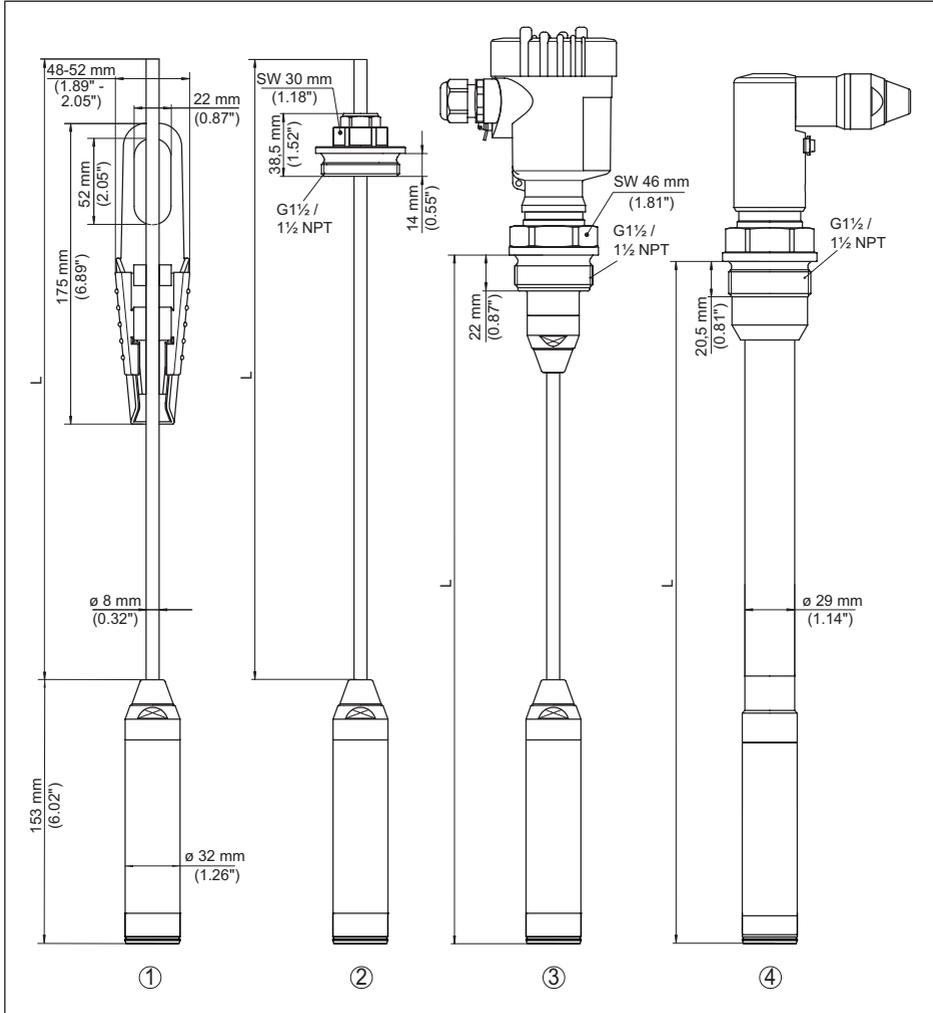
Fig. 31: VEGABAR 86, élément de mesure (32 mm)
