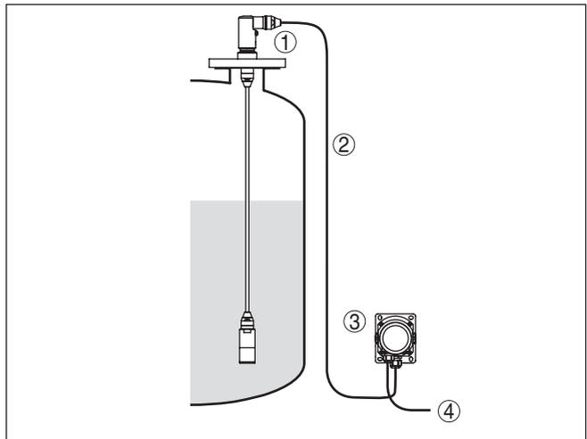
Fig. 7: Disposition voie de mesure, boîtier externe
