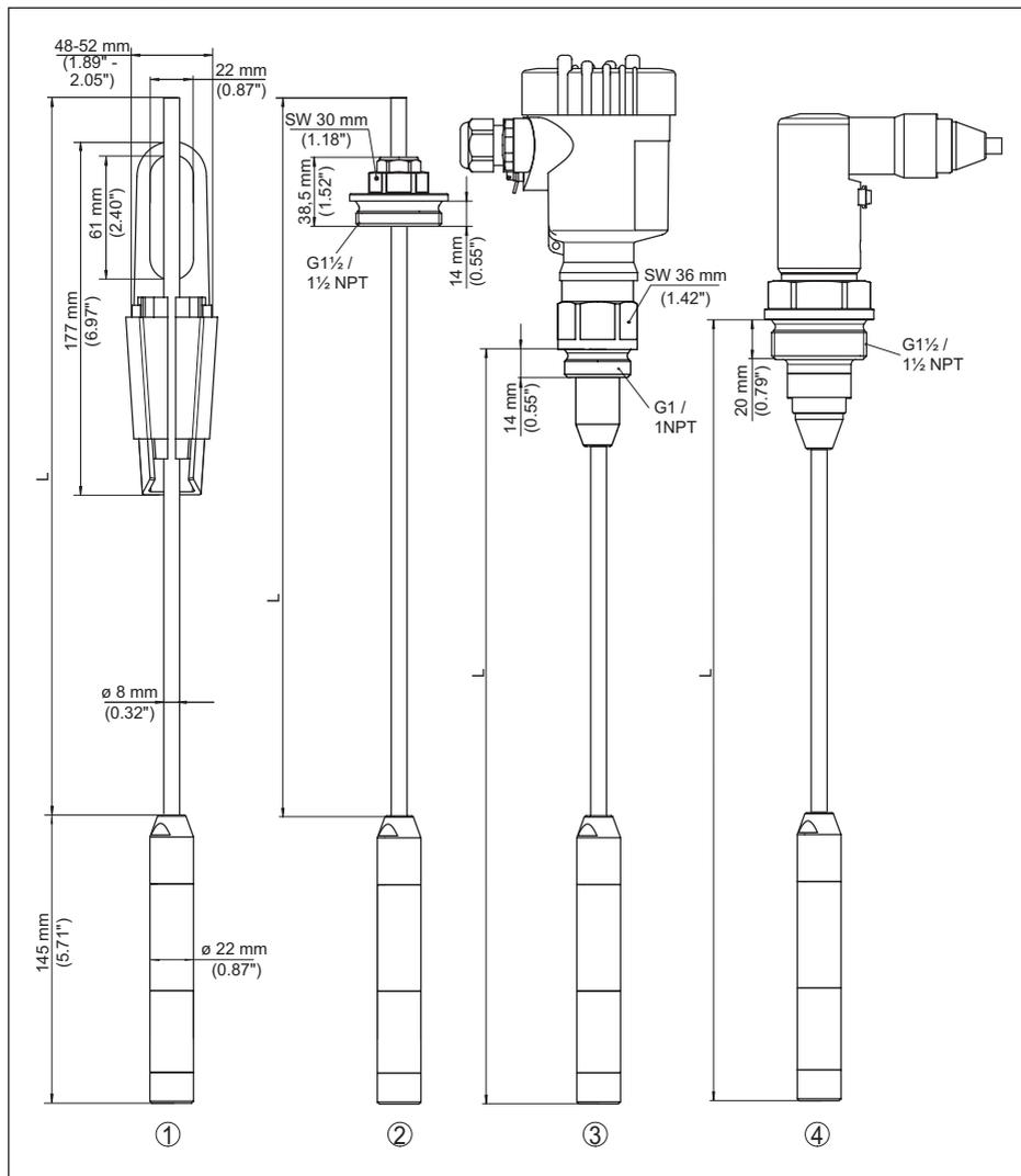
Fig. 32: VEGABAR 86, élément de mesure (22 mm)
