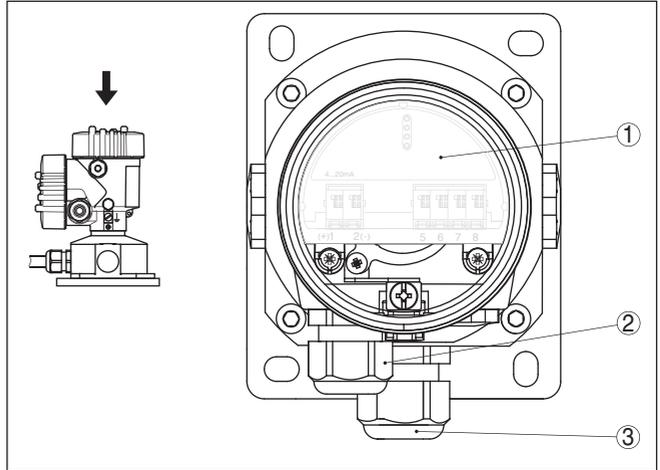
Fig. 13: Compartiment électronique et de raccordement
