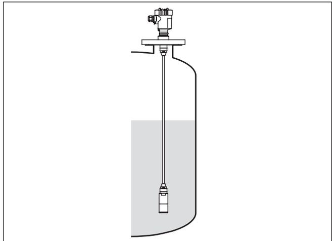
Fig. 2: Mesure de niveau avec VEGABAR 86
