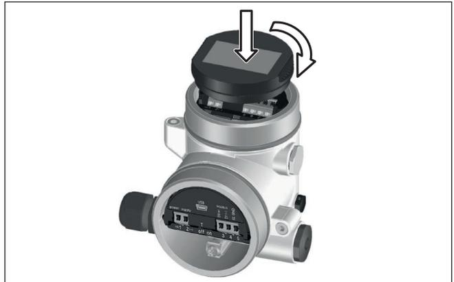
Fig. 15: Insertion du module de réglage et d'affichage
