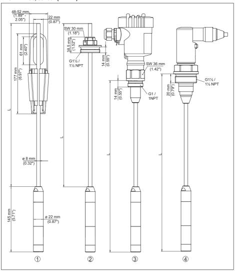
Fig. 32: VEGABAR 86, sensor (22 mm)
