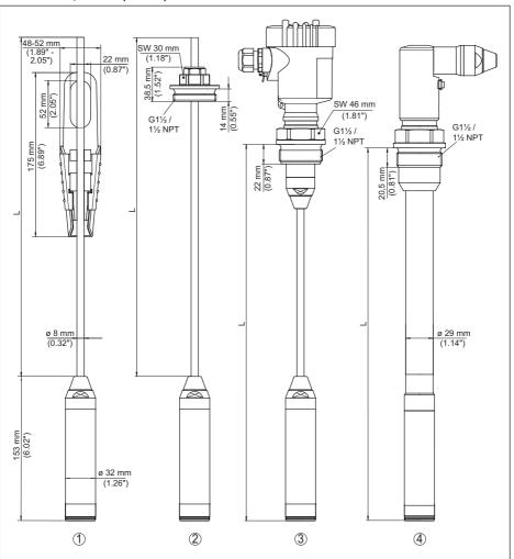
Fig. 31: VEGABAR 86, sensor (32 mm)
