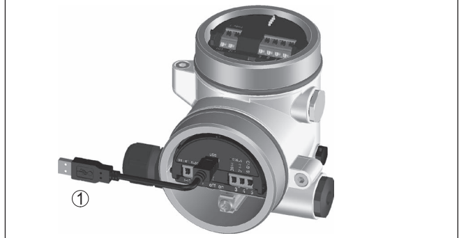
Res. 20: Bilgisayarın USB üzerinden Modbus elektroniğine bağlanması
