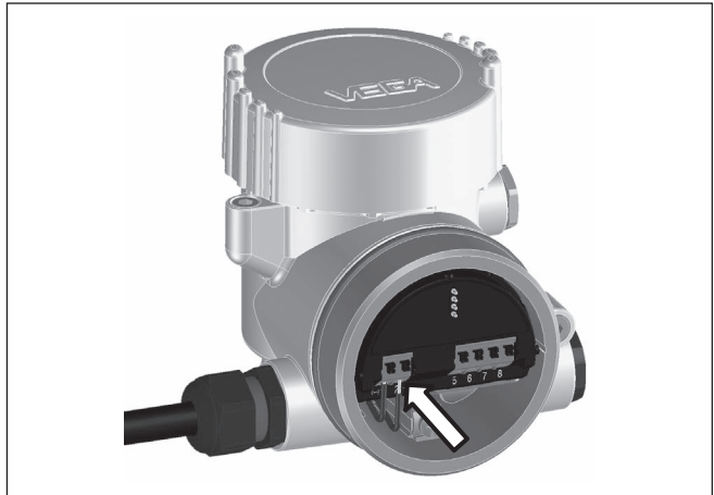
Rys. 13: Czynności przy podłączeniu 5 i 6
