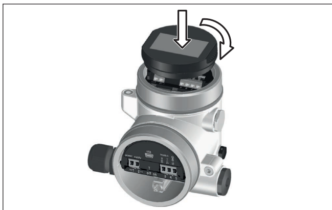
Fig. 21: Inserción del módulo de visualización y configuración
