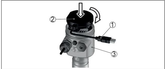
Figura 29: Allacciamento del PC direttamente al sensore tramite adattatore d'interfaccia
