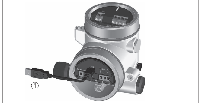
Res. 30: Bilgisayarın USB üzerinden Modbus elektronikğine bağlanması
