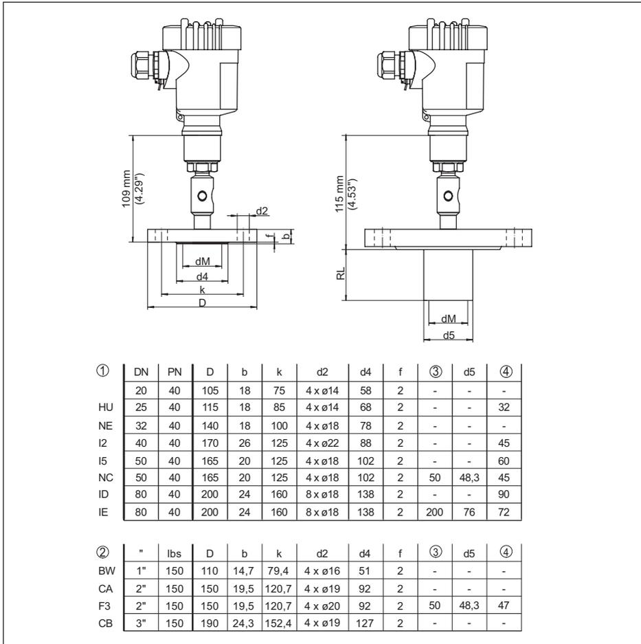
Fig. 44: VEGABAR 81 - Conexión de brida, medidas en mm
