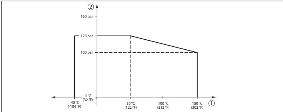
Fig. 32: Reducción de temperatura VEGABAR 81, conexiones a proceso aleación 400 (2.4360)
