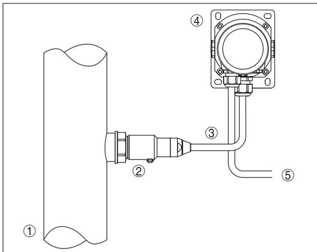
Fig. 12: Disposición módulo de proceso, carcasa externa
