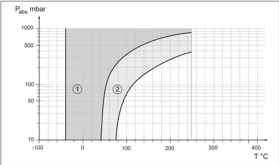
Fig. 33: Rango de aplicación para aceite de silicona VE 2.2, KN 2.2
