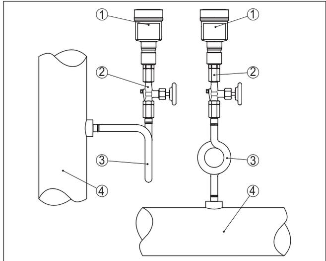
Fig. 9: Configuración de medición para la medición de presión de proceso de vapores en tuberías
