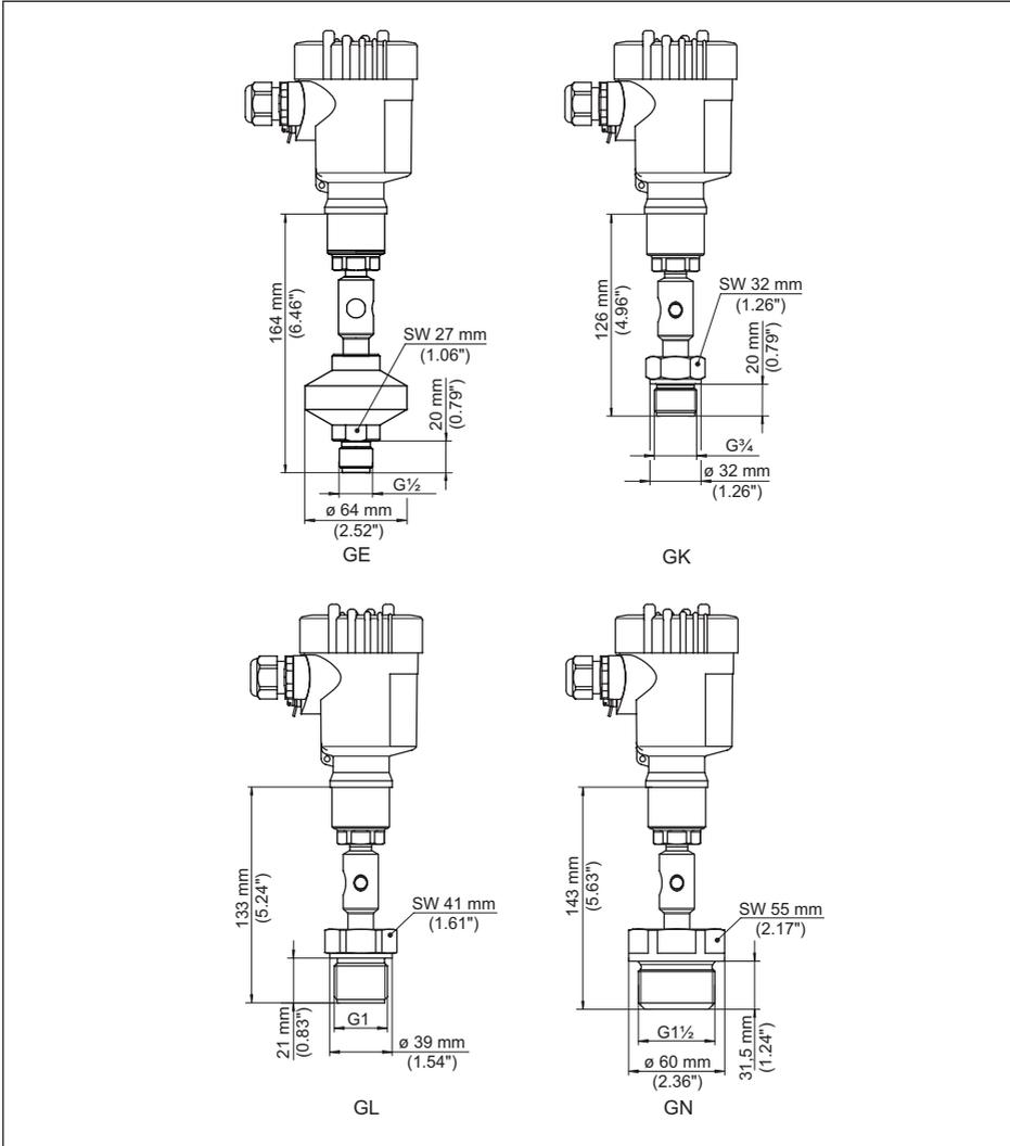
Fig. 42: VEGABAR 81, racor roscado
