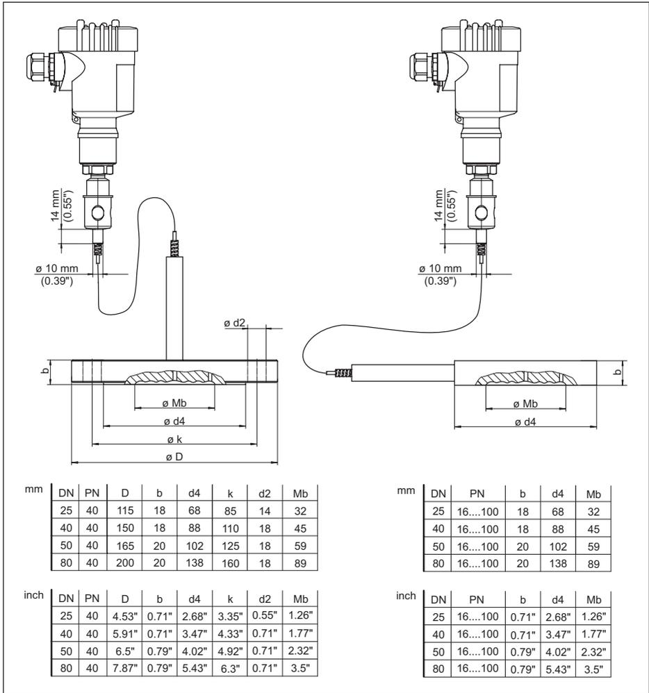
Fig. 46: VEGABAR 81, separador de brida y de celdas con línea capilar
