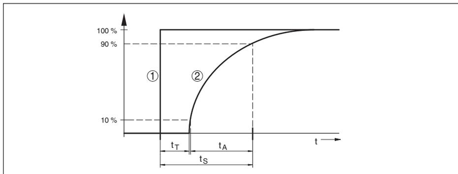
Fig. 31: Variación brusca de la magnitud de proceso.  $t_T$ : tiempo muerto;  $t_A$ : tiempo de subida;  $t_S$ : tiempo de respuesta gradual
