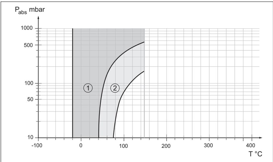
Fig. 38: Rango de aplicación para Neobee M-20 KN 59
