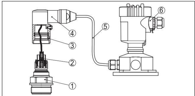
Fig. 30: VEGABAR 81 en versión IP68 25 bar y salida de cable lateral, carcasa externa
