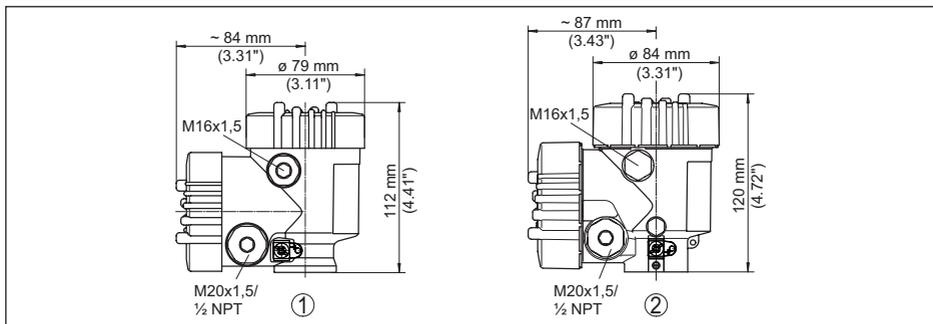
Fig. 40: Medidas carcasa (con módulo de visualización y configuración integrado aumenta la altura de la carcasa en 9 mm/0.35 in o 18 mm/0.71 in)
