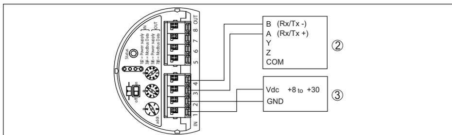
Fig. 39: Conexión del VEGABAR 81 a RTU Fisher ROC 809
