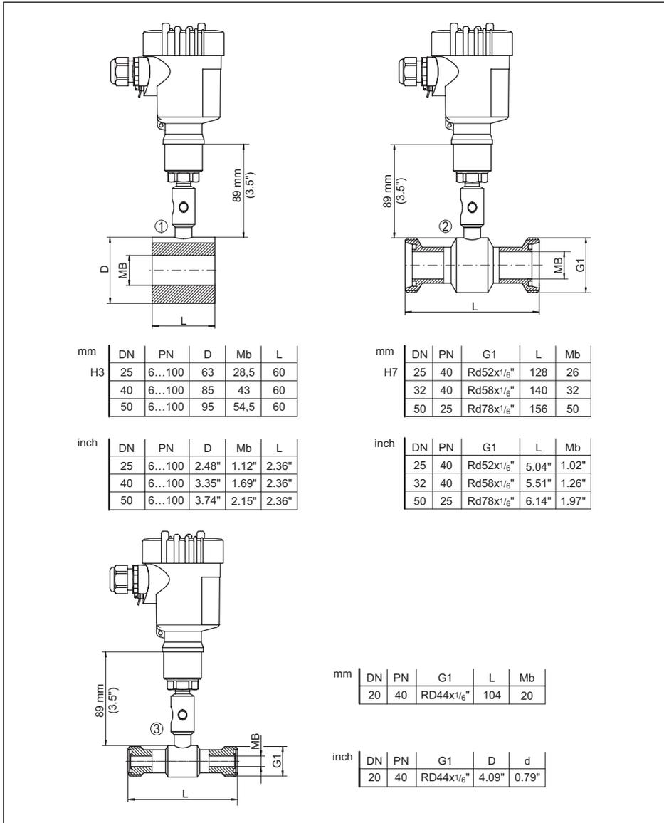
Fig. 43: VEGABAR 81 - Separador tubular
