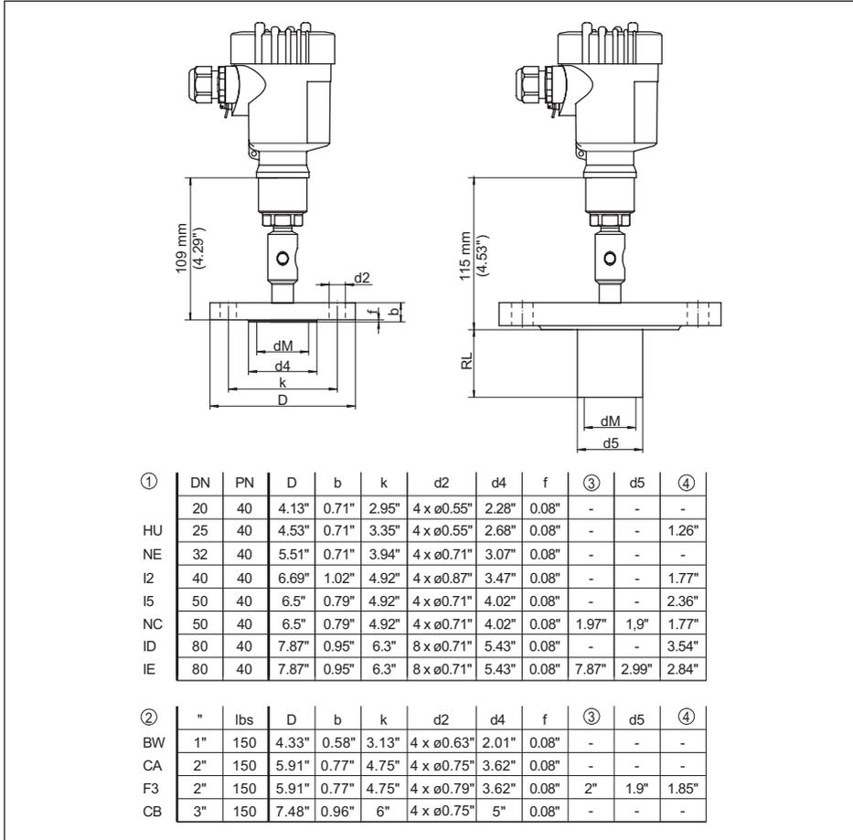
Fig. 45: VEGABAR 81 - Conexión de brida, medidas en pulg.
