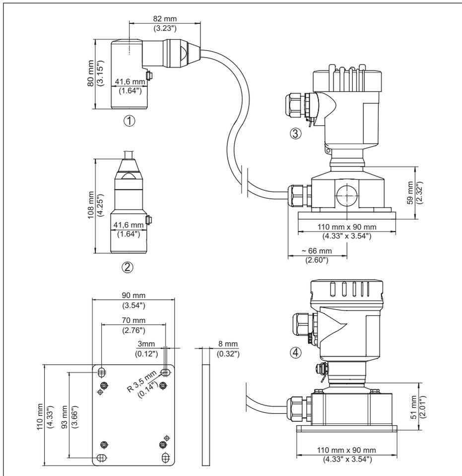
Fig. 41: VEGABAR 81, Versión IP68 con carcasa externa
