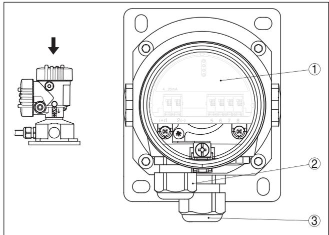
Fig. 18: Compartimento de la electrónica y de conexiones
