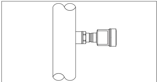
Fig. 2: Medición de presión de proceso con VEGABAR 81
