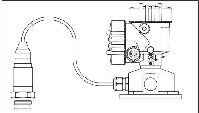
Fig. 17: VEGABAR 81 en versión IP68 25 bar con salida de cable axial, carcasa externa
