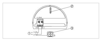
Elektronik- und Anschlussraum Einkammergehäuse
