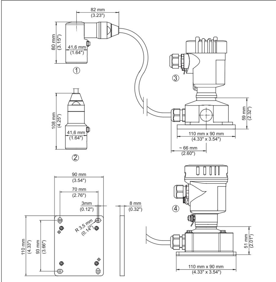
Fig. 29: VEGABAR 87, Versión IP68 con carcasa externa
