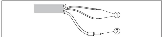
Fig. 13: Dotación de conductores, cable de conexión de conexión fija
