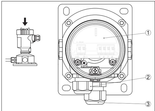
Fig. 15: Compartimento de la electrónica y de conexiones
