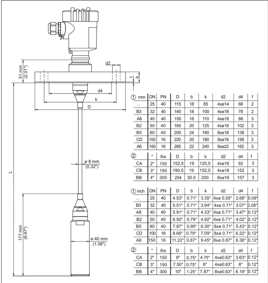
Fig. 31: VEGABAR 87, Conexión de brida
