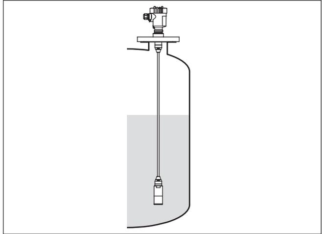
Fig. 1: Medida de nivel con VEGABAR 87
