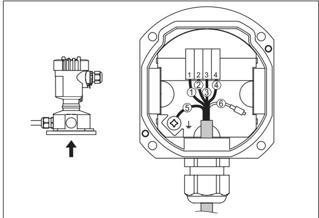
Fig. 14: Conexión del módulo de proceso en el zócalo de la carcasa
