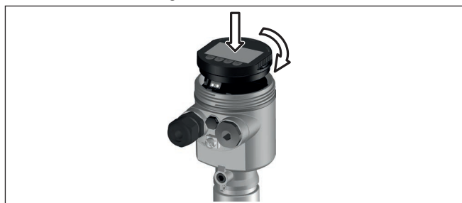
Figura 17: Inserimento del tastierino di taratura con display nel vano dell'elettronica in caso di custodia ad una camera
