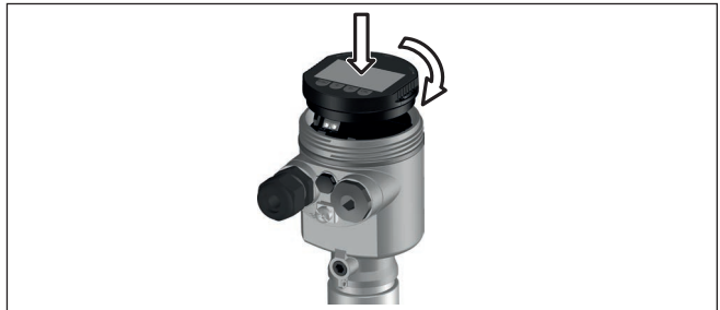
Fig. 17: Montage du module d'affichage et de réglage dans le boîtier à chambre unique se trouvant dans le compartiment de l'électronique
