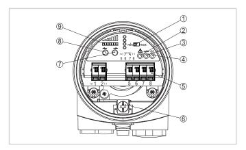
Módulo eletrônico MP60EE.S (unidade receptora) - Saída de transistor
