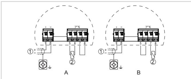
Schéma de raccordement de l'unité réceptrice - VEGAMIP R62 R (Receiver)
