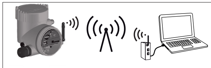
Figura 40: Trasmissione dei valori di misura e parametrizzazione a distanza del sensore attraverso la rete di telefonia mobile
