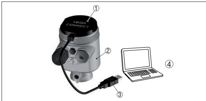
Abb. 34: Anschluss des PCs via VEGACONNECT und USB
