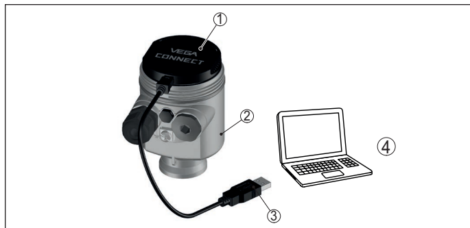
Figura 35: Collegamento del PC via VEGACONNECT e USB
