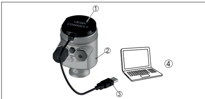
Fig. 35: Raccordement du PC via VEGACONNECT et USB
