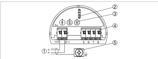
Elektronik- und Anschlussraum Einkammergehäuse
