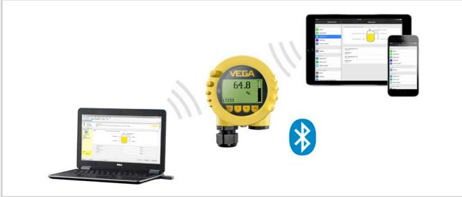
Conexión inalámbrica con instrumentos de configuración estándar
