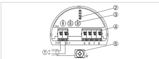
Elektronik- und Anschlussraum Einkammergehäuse
