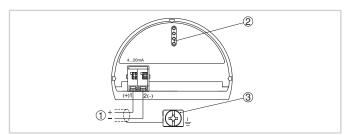
Compartimento de la electrónica y de conexiones carcasa de una cámara
