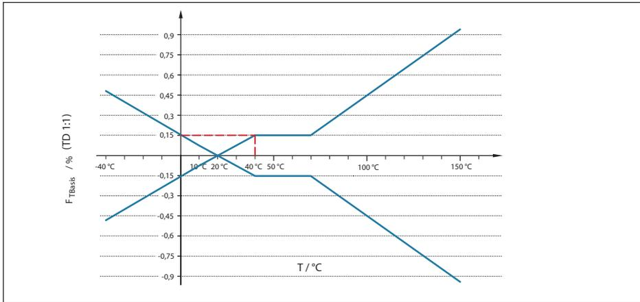
Figura 30: Calcolo dell'errore di temperatura base per il suddetto esempio:  $F_{TBasis} = 0,15\%$
