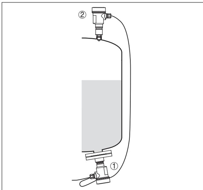
Figura 7: Configurazione di misura per la misura di livello in un serbatoio pressurizzato
