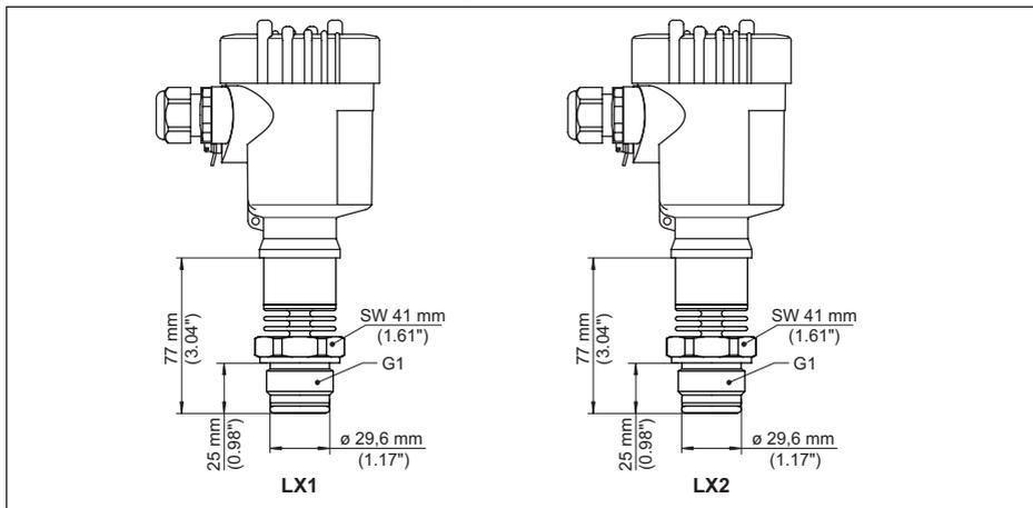
Figura 36: VEGABAR 83, filettatura per adattatore igienico
