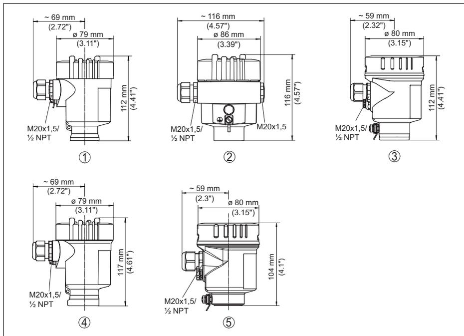
Figura 32: *Differenti custodie con grado di protezione IP66/IP67 e IP66/IP68 (0,2 bar), (con tastierino di taratura con display incorporato l'altezza della custodia aumenta di 9 mm/0.35 in ovv. 18 mm/0.71 in)*
