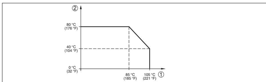
Figura 25: Derating di temperatura VEGABAR 83, esecuzione fino a +105 °C (+221 °F)
