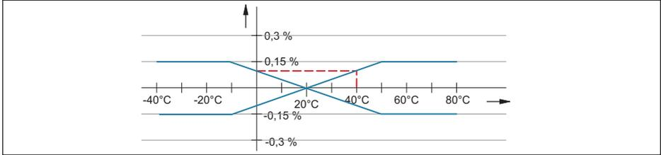
Figura 31:  $F_a$  dovuto a variazione termica dell'uscita in corrente, in questo esempio è 0,1%
