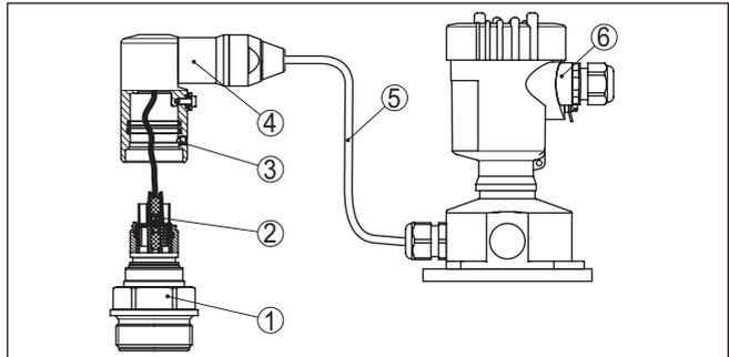
Figura 21: VEGABAR 83 in esecuzione IP68 25 bar e uscita del cavo laterale, custodia esterna
