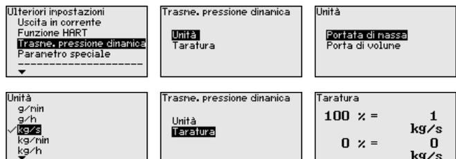
Inoltre viene eseguita la taratura per la portata volumetrica o massica per 0% e 100%.
