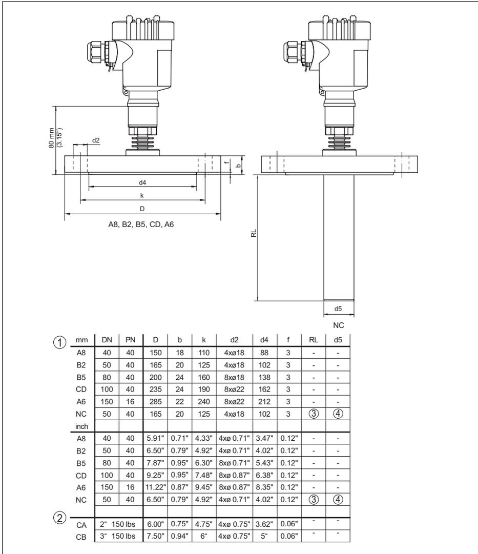
Figura 39: VEGABAR 83, attacco a flangia +150 °C (cella di misura piezoresistiva/DMS)
