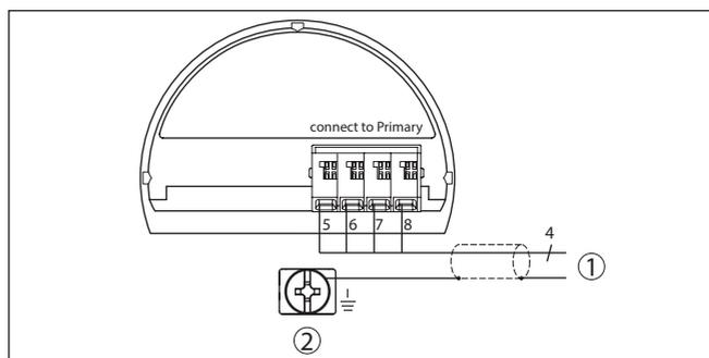
Figura 14: Schema di collegamento VEGABAR 83 secondary device
