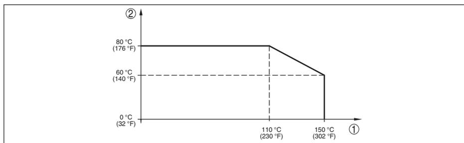
Figura 27: Derating di temperatura VEGABAR 83, esecuzione fino a +150 °C (+302 °F)
