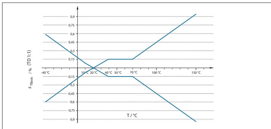
Figura 23: Errore di temperatura base  $F_{TBasis}$  con TD 1 : 1
