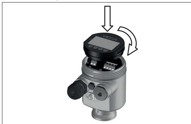
Fig. 22: Colocação do módulo de visualização e configuração na caixa de uma câmara no compartimento do sistema eletrónico
