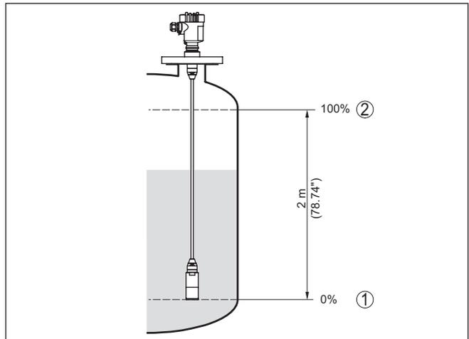
Fig. 30: Exemple de paramétrage réglage min./max. mesure de niveau
