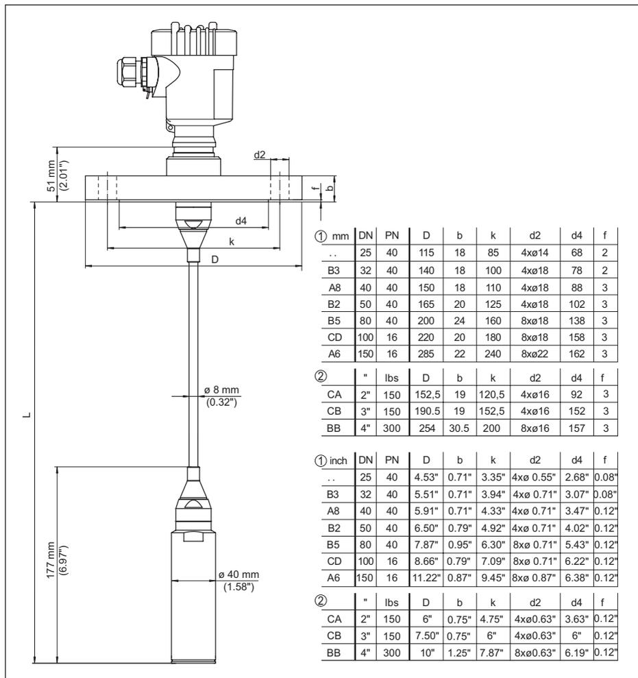
Fig. 48: VEGABAR 87, raccord à bride
