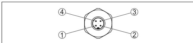
Fig. 20: Vue sur le connecteur M12 x 1
