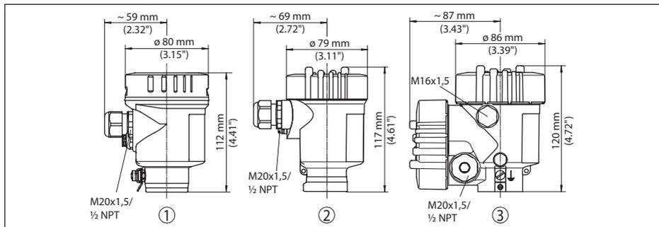
Fig. 43: Variantes de boîtier en protection IP66/IP68 (0,2 bar), (avec un module de réglage et d'affichage intégré, la hauteur du boîtier augmente de 9 mm/0.35 in ou 18 mm/0.71 in)
