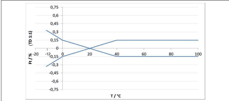
Fig. 37: Erreur de température de base  $F_{T\text{Basis}}$  avec TD 1 : 1
