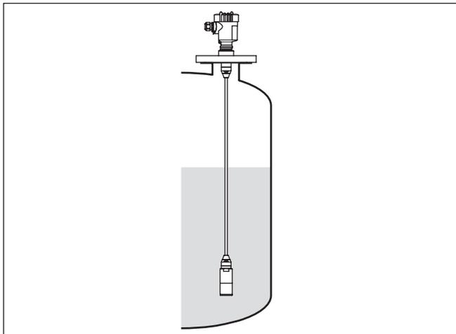
Fig. 1: Mesure de niveau avec VEGABAR 87
