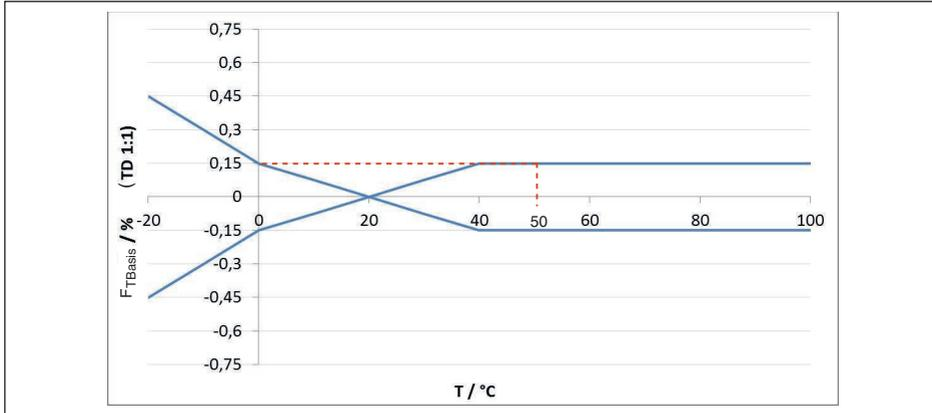
Fig. 39: Détermination de l'erreur de température de base pour l'exemple ci-dessus :  $F_{TBasis} = 0,15\%$
