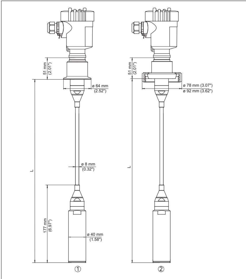
Fig. 49: VEGABAR 87, raccords aseptiques
