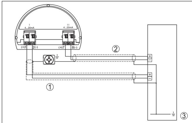
Fig. 25: Exemple de raccordement VEGABAR 87 sortie courant supplémentaire
