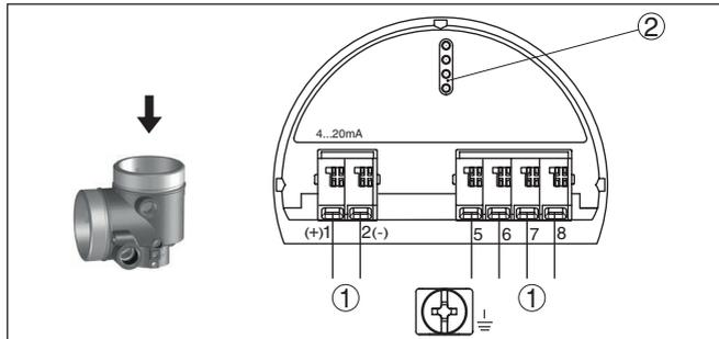
Fig. 13: Compartiment électronique - boîtier à deux chambres
