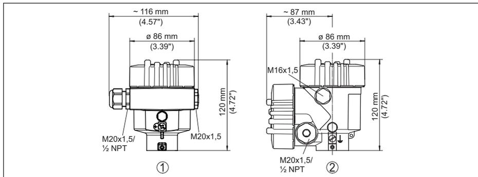
Fig. 41: Variantes de boîtier en protection IP66/IP68 (0,2 bar), (avec un module de réglage et d'affichage intégré, la hauteur du boîtier augmente de 18 mm/0.71 in)
