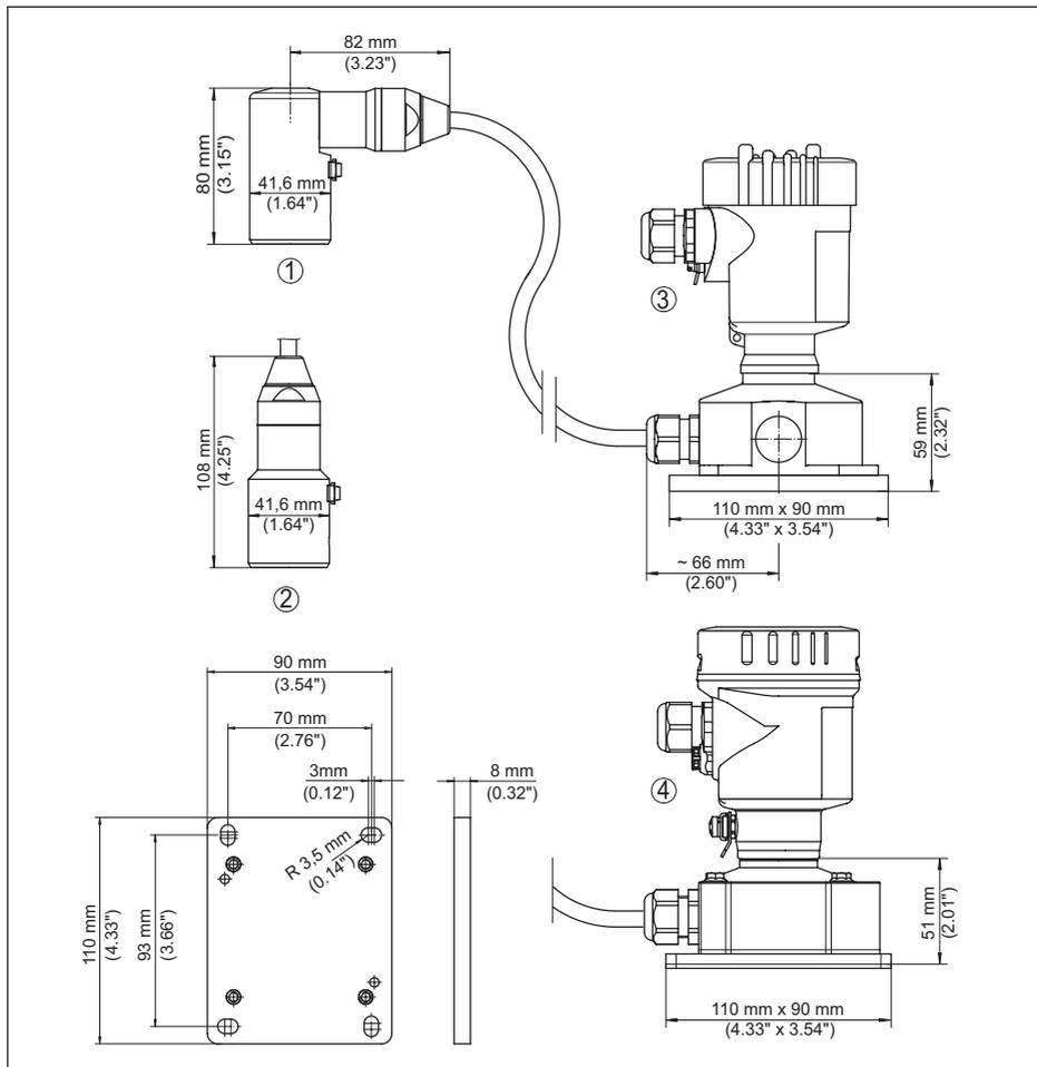
Fig. 46: VEGABAR 87, version IP68 avec boîtier externe
