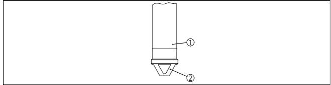
Fig. 5: VEGABAR 87, protection de transport et de montage
