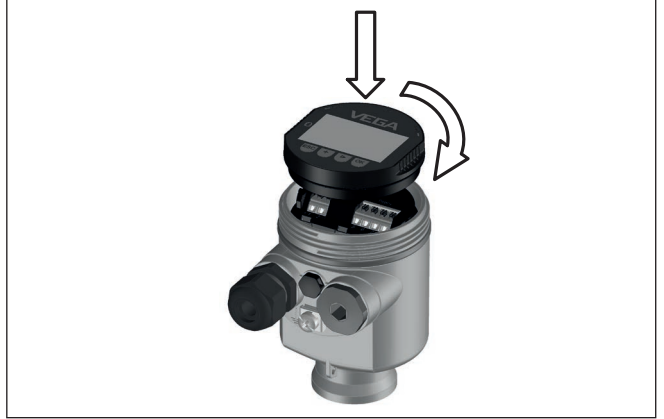
Res. 21: Elektronik bölümünde bir hücreli gövdede gösterge ve ayar modülünün çalıştırılması
