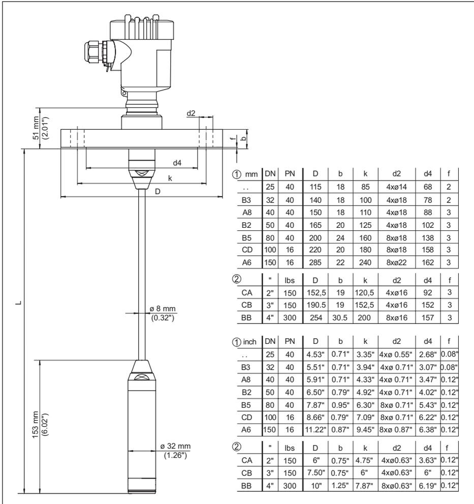
Abb. 50: VEGABAR 86, Flanschanschluss (Beispiel: Messwertaufnehmer 32 mm)
