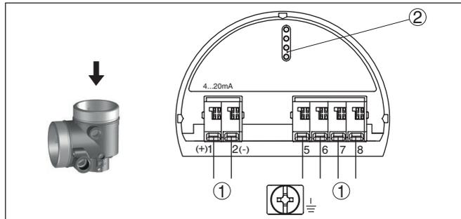
Abb. 13: Elektronikraum - Zweikammergehäuse
