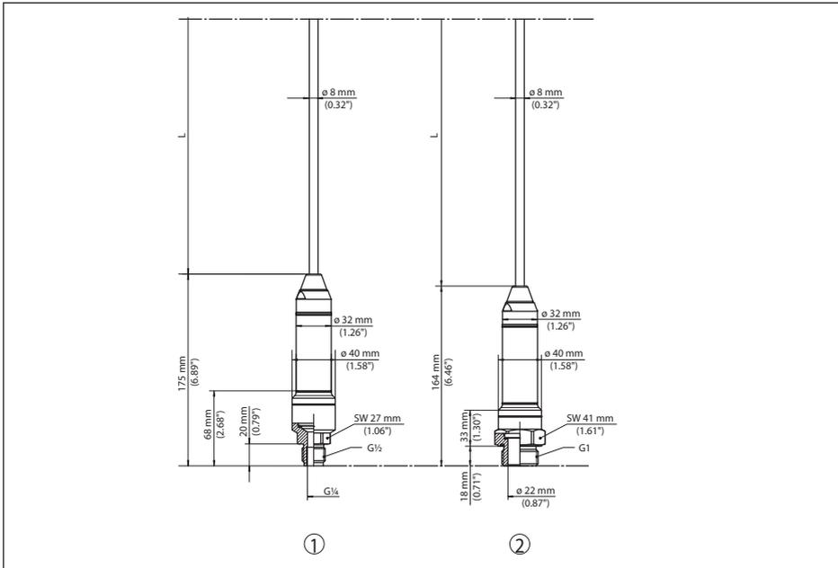
Abb. 52: VEGABAR 86, Gewindeausführung
