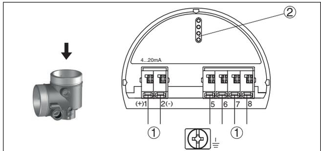
Abb. 17: Elektronikraum - Zweikammergehäuse
