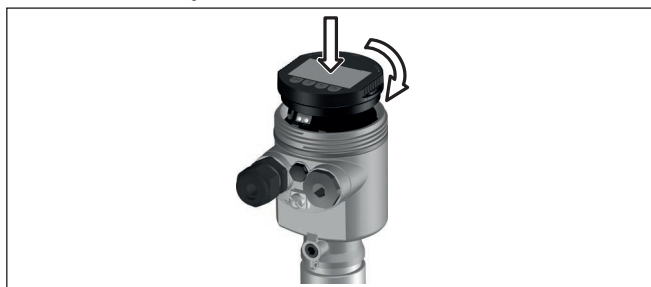
Fig. 23: Colocação do módulo de visualização e configuração na caixa de uma câmara no compartimento do sistema eletrónico
