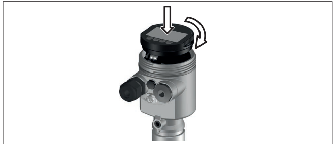
Fig. 23: Plaatsen van de display- en bedieningsmodule bij eenkamerbehuizing in elektronicaruimte.
