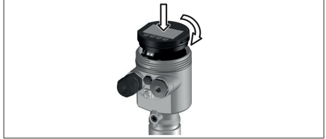
Res. 23: Elektronik bölümünde bir hücreli gövdede gösterge ve ayar modülünün çalıştırılması
