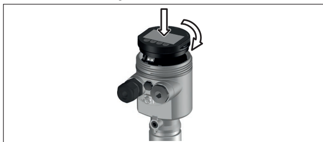
Figura 23: Inserimento del tastierino di taratura con display nel vano dell'elettronica in caso di custodia ad una camera
