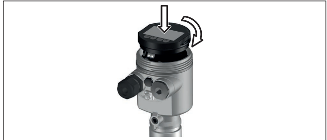
Abb. 23: Einsetzen des Anzeige- und Bedienmoduls beim Einkammergehäuse im Elektronikraum
