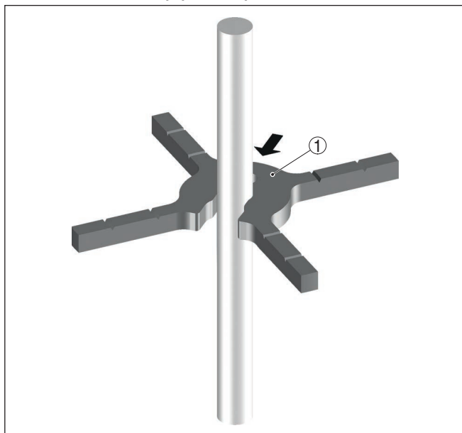
Figura 9: Montaggio della stella di centraggio (aperta lateralmente)
